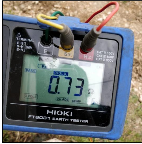
Şekil 6. Seçilen Pilot Bölgede Uygulama Sonrası Alınan Ölçüm (0.73 ohm)
