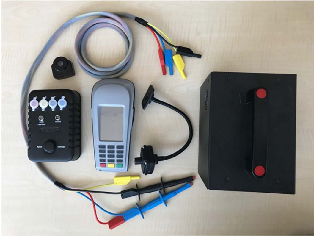
Şekil 1 Sayaç Test Cihazı bileşenleri
